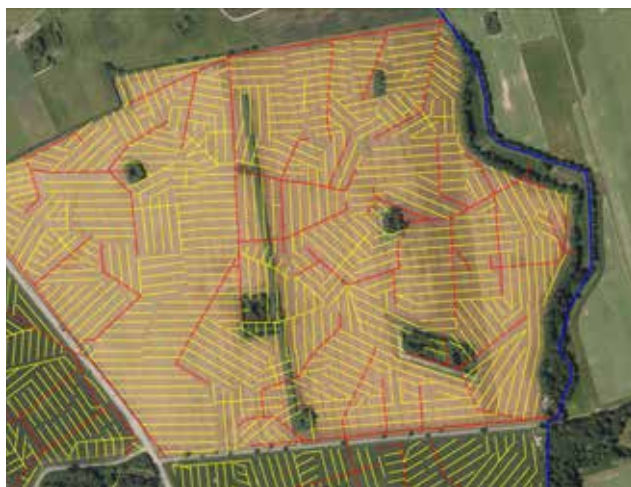
Drænkort for en systematisk drænet mark på lerjord. Drænene er etableret som tegl eller plastrørsledninger med 12-16 meters mellemrum, der samles i hovedledninger, der leder vandet ud i vandløb.
